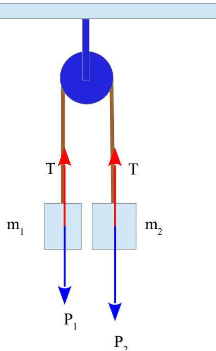
Los dos cuerpos tiran con distinto peso de la cuerda, como un cuerpo tiene más peso que el otro la resultante será distinta de cero y el sistema se moverá con aceleración. Según la segunda ley de Newton la aceleración será proporcional a la resultante. Podemos aplicar la segunda ley de Newton al conjunto de los cuerpos o a cada uno por separado, ya que se mueven con la misma aceleración.
